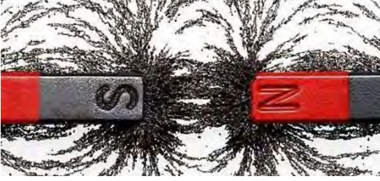
Resim 1.18. Zıt kutuplu mıknatısların çevresindeki demir tozları
