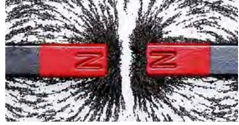
Resim 1.19. Aynı kutuplu mıknatısların çevresindeki demir tozları
