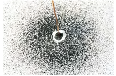
Resim 1.21. İletken telin manyetik alanında demir tozlarının davranışı
