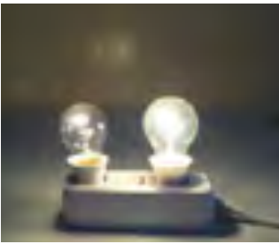
Resim 1.10. Aynı gerilimde farklı parlaklıkta yanan ampuller
